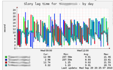
Figura 4: Ejemplo de gráfica por plugins de Munin Exchange: Demoras para un cúmulo Slony (gráfica obtenida de la página del plugin en Munin Exchange)
